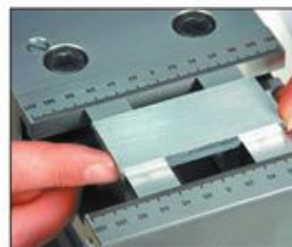
Werkstückrohling nach Augenmaß mittig einlegen und spannen
