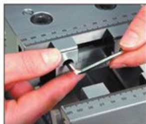
Außenkante der Einsätze ca. 2 mm unterhalb Fertigmaß erstellen
