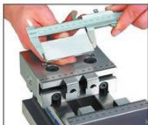
Rohling liegt ca. 2 mm über dem Fertigmaß.
