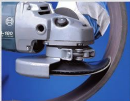
用COMBICLICK® 纤维轮所进行的端面磨削过程中柔软并且非常灵活的磨削特性
