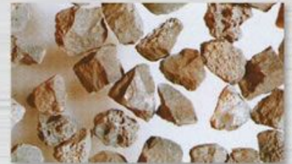
KA bzw. Z = 锆刚玉, 非常高的机械强度
