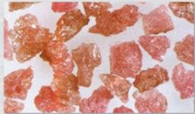
EKD = 高级刚玉, 粉红色 非常硬, höhere Kurzzähigkeit als EK 与普通刚玉相比具有更高的
