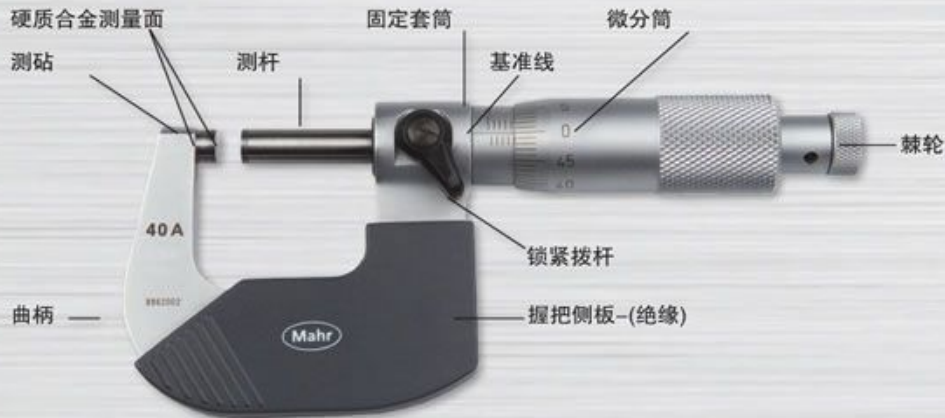
b)带刻度显示和圆度盘的机械式千分尺
